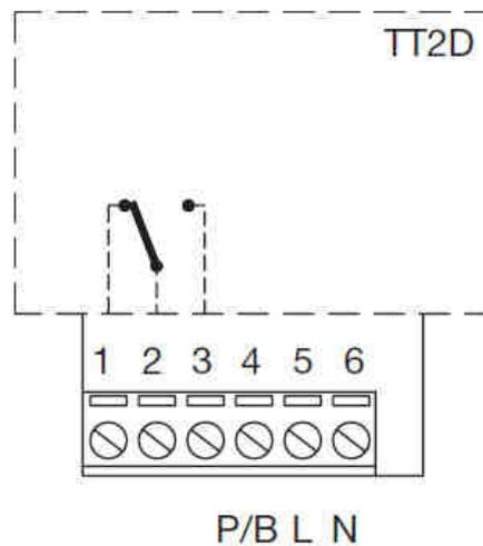
Remarque : La tension d'alimentation de ce récepteur est 230Vac. Il ne fonctionnera pas avec une tension d'alimentation inférieure.
