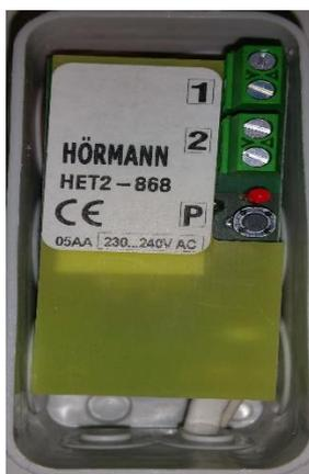
1. Auf dem Empfänger, drücken Sie die Programmierertaste P: einmal für Kanal 1, zweimal für Kanal 2. Die LED am Empfänger blinkt einmal für Kanal 1, zwei Mal hintereinander für Kanal 2.
