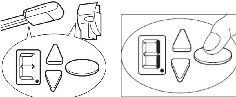
1. Repérer sur le moteur NOVOFERM l'afficheur et les 3 touches de programmation
