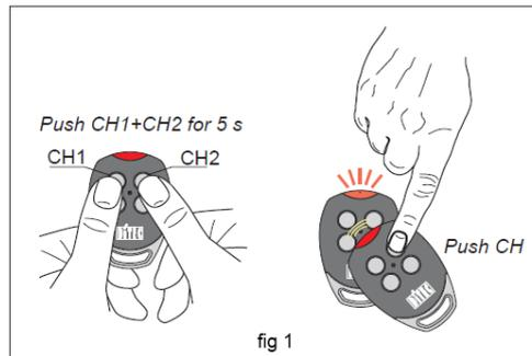
1. Appuyez en même temps sur les touches 1 et 2 de votre nouvelle télécommande pendant 5 secondes. La diode de la télécommande s'allume.
