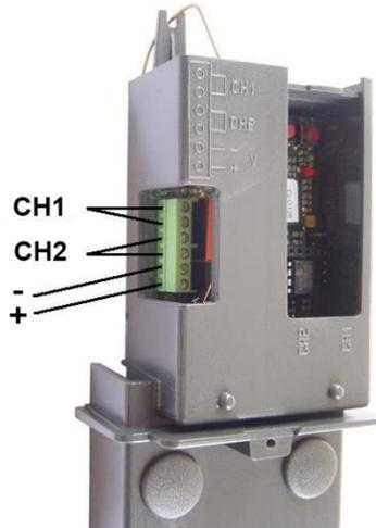
1. Coupez le courant de l'installation. Vérifiez que l'alimentation est de 12V ou 24V, courant alternatif ou continu. Branchez l'alimentation entre les bornes « - » et « + » (pas de sens à respecter si le courant est alternatif). Si la tension de l'alimentation est plus élevée, vous devrez installer un transformateur adapté à l'amont du récepteur.
