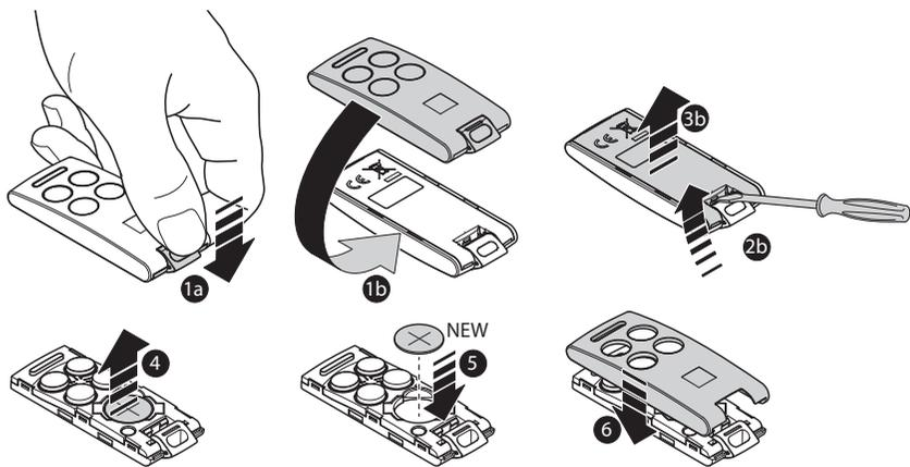
Batteria litio - Lithium battery - Batterie lithium - Lithiumbatterie - Batería litio: **3V 1 x CR2032**
