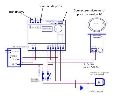
En cas de remplacement d'un contact T25 mécanique, câblez simplement les 2 fils existants en C et NO.
