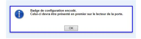
Il est impératif de créer d'abord le badge de configuration et ce dernier doit être obligatoirement présenté en premier sur la centrale pour permettre la configuration de la centrale.
