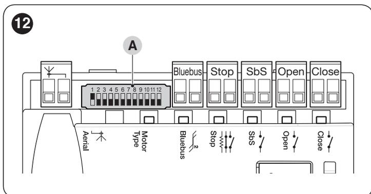
**La configuration du sélecteur moteur doit être effectuée avant la reconnaissance des positions des butées mécaniques.**
