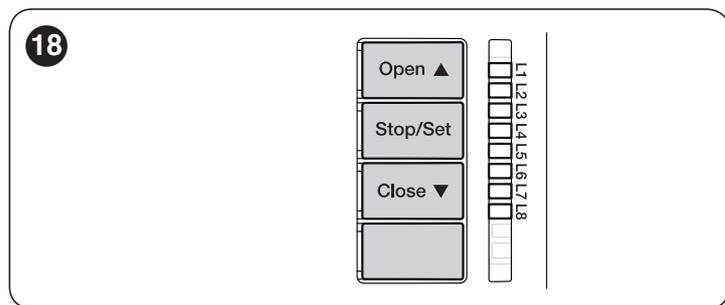
Les fonctions programmables disponibles sont installées sur **deux niveaux** et leur état de fonctionnement est signalé par huit led « **L1 ... L8** » présentes sur la centrale (led allumée = fonction active ; led éteinte = fonction non active).
