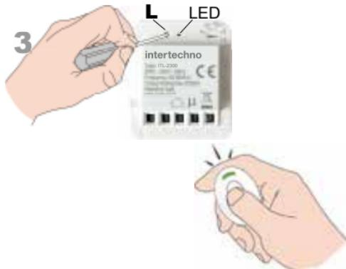
Das Funk-Mini Einbaumodul ITL-2300 ist für die drahtlose EIN-Ausschaltung bis 2300 Watt geeignet.
