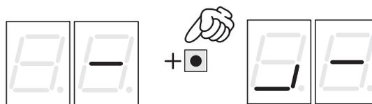
Pour que l'automatisme puisse fonctionner correctement, l'état des segments du caractère de gauche doit correspondre aux indications de l'image ci-contre, correspondant à la situation d'automatisme au repos et sans générateurs d'impulsion ni sécurités engagées.
