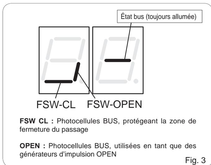
Sur la page-écran de l'état des dispositifs BUS, une pression sur la touche + permet de vérifier les types de dispositifs BUS inscrits. par exemple, l'image suivante indique qu'il y a autant de dispositifs de sécurités en fermeture inscrits qu'il y a de paires de photocellules ayant une fonction d'impulsion d'ouverture :
