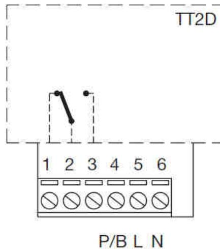
**Achtung:** Die Betriebsspannung von diesem Empfänger ist 230V. Der wird mit einer niedrigeren Betriebsspannung nicht funktionieren.
