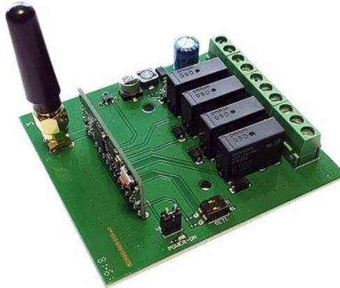
LoRa RC4 est un récepteur bi-directionnel fonctionnant à 868,3MHz avec modulation LoRa® et est capable de garantir des communications à très longue distance, haute immunité aux interférences, haute sensibilité et faible consommation d'énergie.
